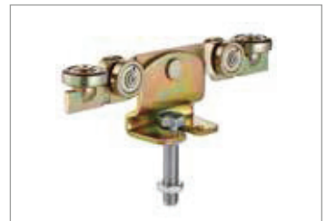
Serie -91 EL doppelpaariger Rollapparat mit Pendelgelenk aus Kunststoff bzw. Stahl, mit 2 Querrollen fur elektrisch betriebene Tore, hohenverstellbar
