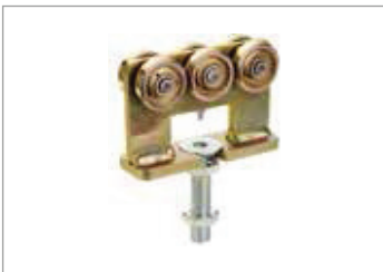
Serie -92 doppelpaariger Rollapparat mit Pendelgelenk aus Kunststoff bzw. Stahl und mit Gegendruckrolle fur Schiebeflugel mit Klappflugel, hohenverstellbar
