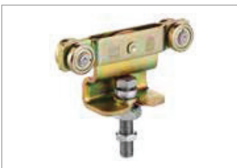
Serie -91/85 doppelpaariger Rollapparat mit Pendelgelenk aus Stahl fur Feuerschutz-Schiebetore, hohenverstellbar
