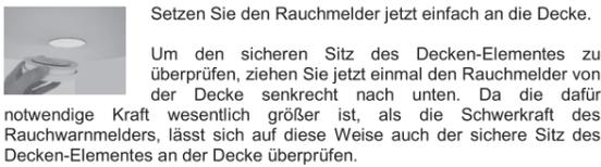
Setzen Sie den Rauchmelder jetzt einfach an die Decke. Um den sicheren Sitz des Decken-Elementes zu überprüfen, ziehen Sie jetzt einmal den Rauchmelder von der Decke senkrecht nach unten. Da die dafür notwendige Kraft wesentlich größer ist, als die Schwerkraft des Rauchwarnmelders, lässt sich auf diese Weise auch der sichere Sitz des Decken-Elementes an der Decke überprüfen.
