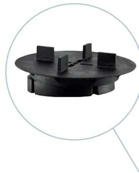
Alle **Platten-Stelzlager** lassen sich auch ideal mit unserem **TERRASYS Plattenlager SN** (Selbstnivellierendes Plattenlager mit rundum 4,7°-Neigungswinkel) kombinieren. Dieses **erspart** das **Ausgleichen** des **Untergrunds** bis zu einem **Gefälle** von **8,2%**.
